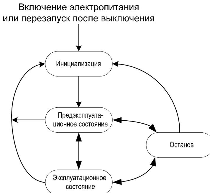
Рис. 3-1. Схема состояний дозатора в сети связи CANopen
